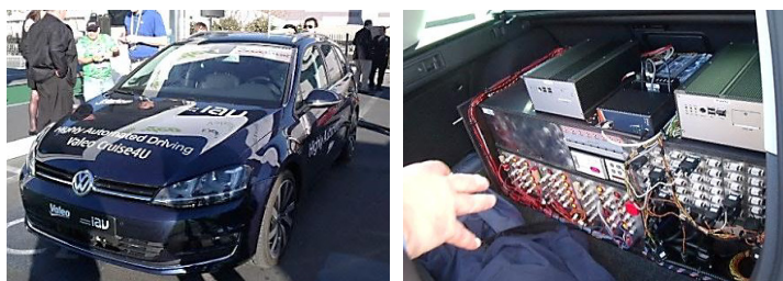
図表4-3 ValeoとIAVが共同開発した自動運転車（左）と トランクルーム内の制御ユニット（右）
