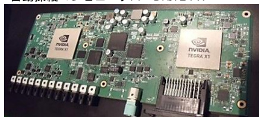
図表8-2 NVIDIAの高速動画処理プロセッサ‘Tegra X1’を2個搭載し、機械学習機能を持つ自動操縦コンピュータPF ‘DRIVE PX’
