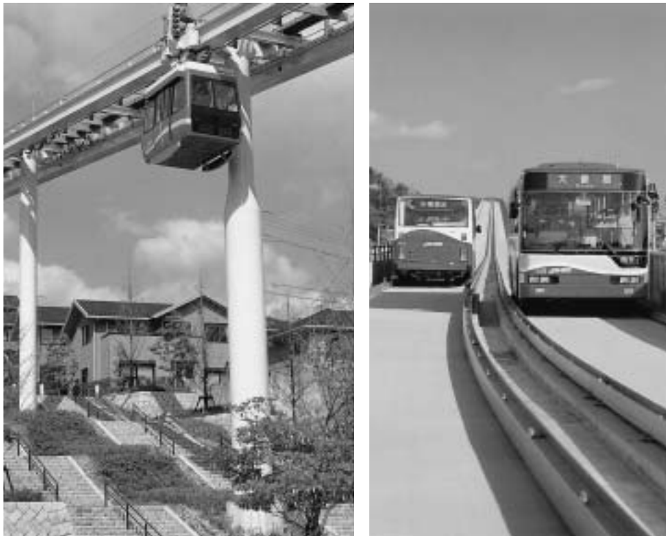
図表 1 - 6 スカイレール（左）とガイドウェイバス（各社パンフレットより）
