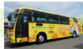
岩手県北自動車の貨客混載バス(ヒトものバス)には、車両後方の座席を10席分減らして荷台スペースを確保した開発車両が導入されている。2015年度グッドデザイン賞を受賞した。
