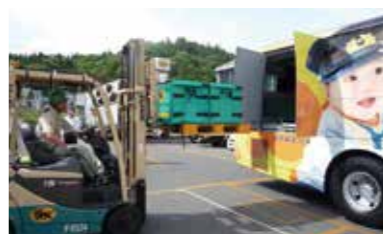
岩手県北自動車の貨客混載バス(ヒトものバス)には、車両後方の座席を10席分減らして荷台スペースを確保した開発車両が導入されている。2015年度グッドデザイン賞を受賞した。
