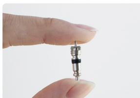
同社のバルブコア(タイヤの空気注入口(バルブ)内部に組み込まれ、空気漏れを防ぐ逆止弁機能を持つ小型精密部品)
