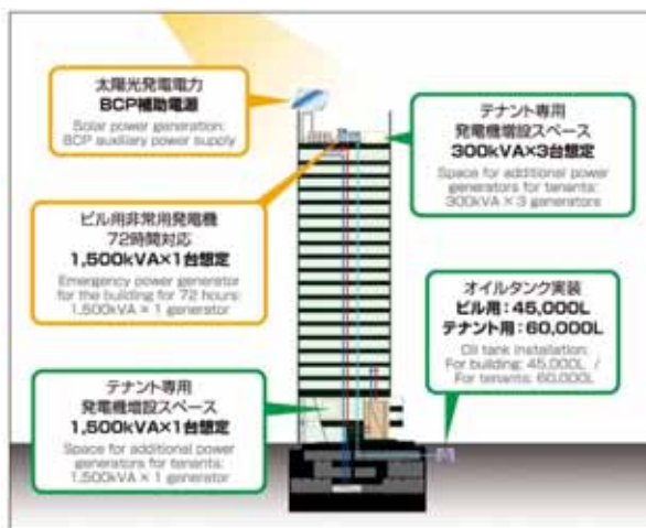
電力供給のバックアップ
