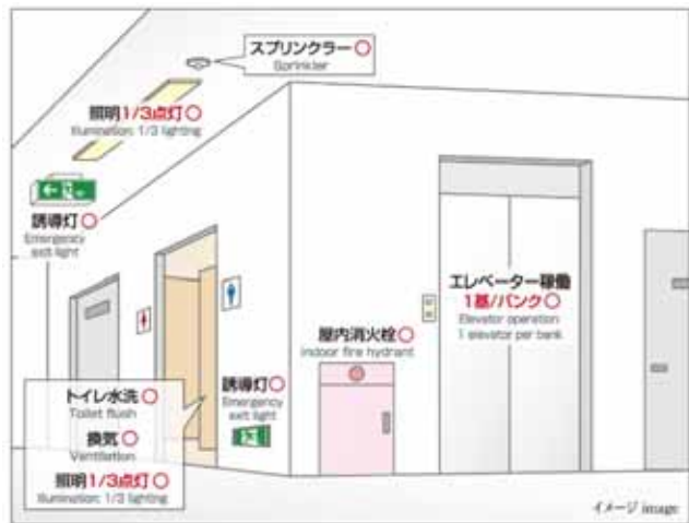
ビル共用部の停電時電力供給
