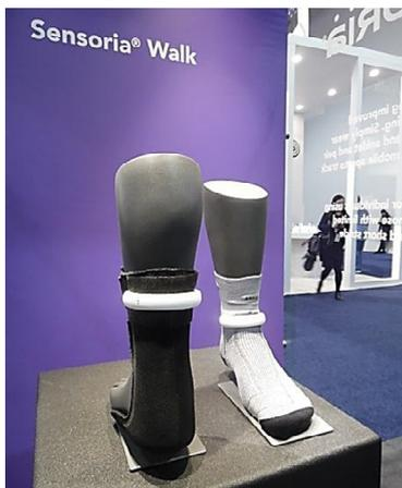
靴下の繊維の中に圧力センサを3つ織り込み、足にかかる圧力を測定
