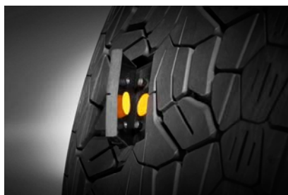
図表2-10 「ContiSense」 タイヤに内蔵されたセンサ部分
