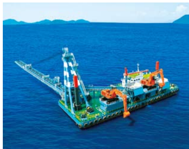
バックホウ式リクレーマ船「オーシャン5号」
