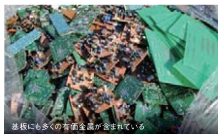
基板にも多くの有価金属が含まれている
