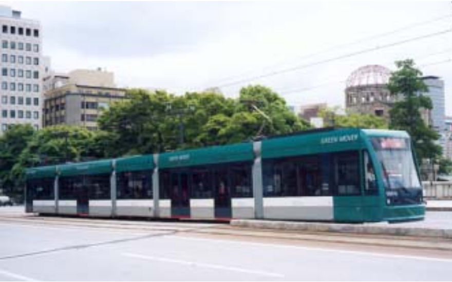
超低床路面電車(広島県広島市) ～広島電鉄株～ 超低床路面電車<グリーンムバー>は、ホームとの段差が少なく、車椅子やベビーカーでの乗降もスムーズに行うことができます。また、国際平和都市広島都市景観への配慮から、広島都市アイデンティティ「水と緑」を表す車両カラーを使用するなど車両デザインも工夫されています。
