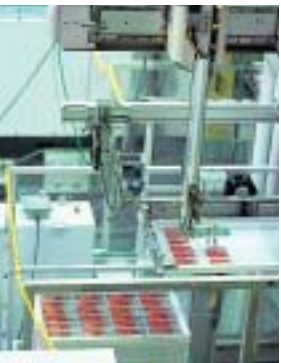
全自動化された携帯電話の工場内部。21台の成形マシンが24時間体制で稼働し、1台当り5,000ピース/日を生産する。
