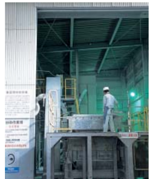
端材や廃材の処理設備。粉碎機で処理された後は、リサイクル資源として使用される。
