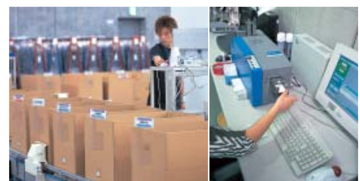
ICタグの発行作業（右上）とLBL。全国800店舗別に商品を箱詰め（左上）した後、箱に貼付されたICタグの情報を読んで即座に帳票を発行する（左下）。多い日には1日4～5万点の入出荷をこなす（先端情報工学研究所・東扇島物流センター）。
