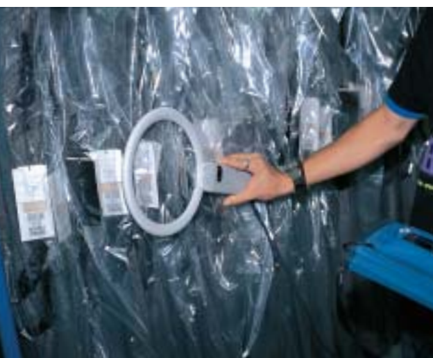
丸型アンテナでICタグの情報を読み取り、入荷検品を行う。
