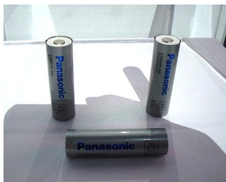
図表7-6 Teslaの新型電気自動車「モデルS」を展示するパナソニックのブース（左）と 同社がTeslaに供給する円筒型リチウムイオン電池（右）
