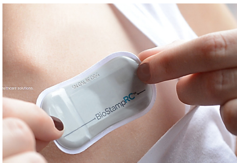
図表3-2 mc10 伸縮するセンサを皮膚に貼り付けるウェアラブル「バイオスタンプ」
