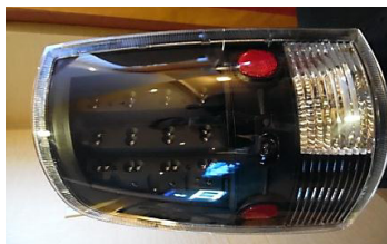
図表7-5 カナダLeddarTech LED型LiDARをランプに組み込み
