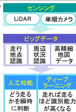
図表7-2 NVIDIAの自動運転コンピュータプラットフォーム‘DRIVE PX2’自ら学習する人工知能を搭載
