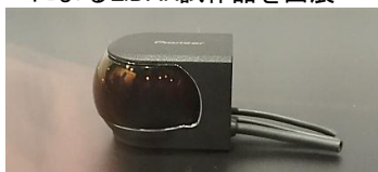
図表7-5 カナダLeddarTech LED型LiDARをランプに組み込み
