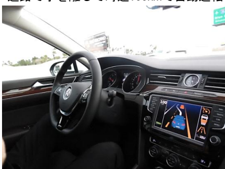
図表7-3 仏Valeoの半自動運転車 高速道路で手を離して時速100kmで自動運転
