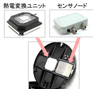
図表16 マンホールを活用した 下水道氾濫検知システム
