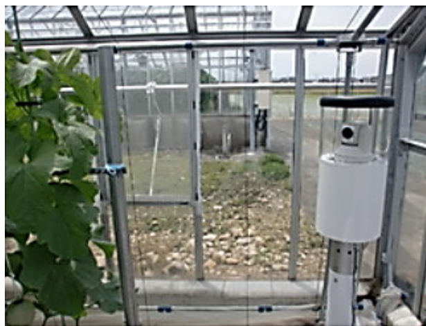
図表18 カメラや各種センサを搭載した「フィールドサーバー」
