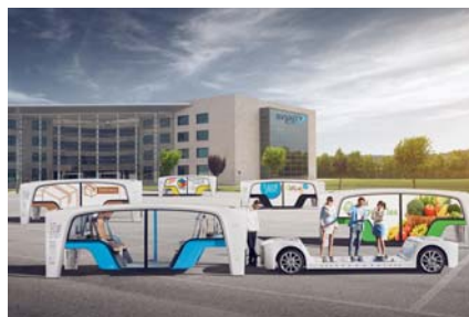
図表2-13-1 用途に応じて 車体を変更可能
