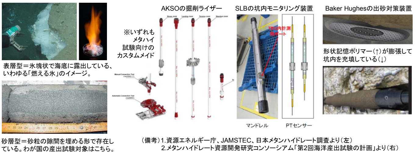
図表14-1 メタンハイドレートおよび第2回海洋産出試験(2016～17年)でのSPV各社提供技術
