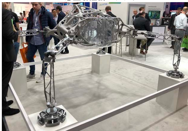
図表5-3 ジェネレーティブデザインで作成された惑星着陸機のデザイン
