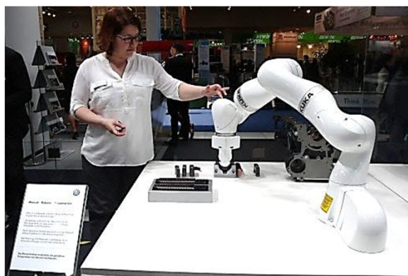
図表5-2 VW 人とロボットが同時に作業
