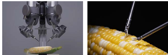
マイクロサージャリーロボットによるトウモロコシ粒の縫合
