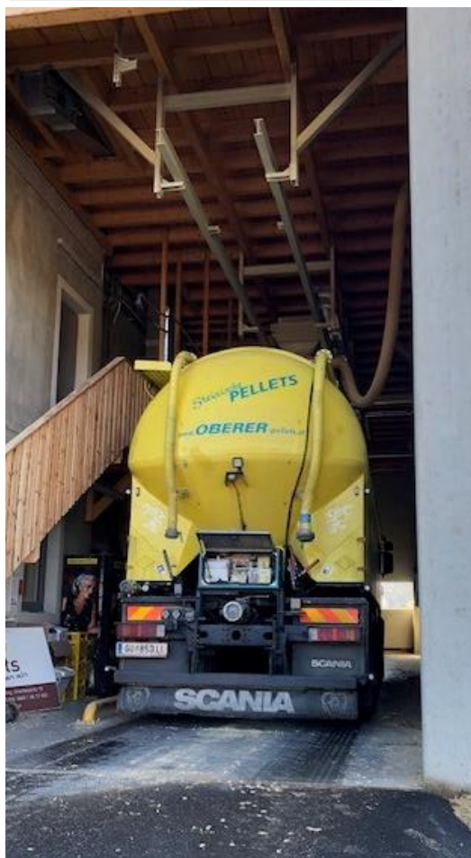
写真3-12 ペレット配給用タンクローリー
