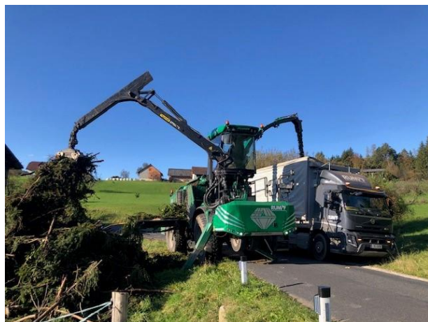
写真3-1 枝葉現地チップングの様子
