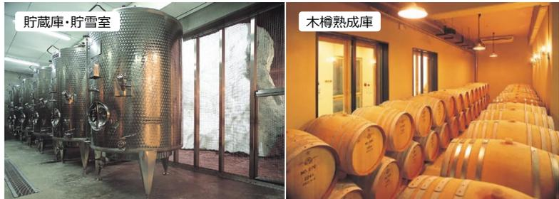
※雪とタンク間のシャッター開閉により温度調整
