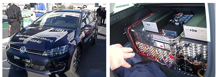
図表4-3 ValeoとIAVが共同開発した自動運転車（左）とトランクルーム内の制御ユニット（右）
