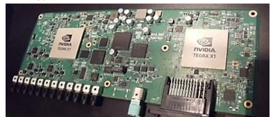
図表8-2 NVIDIAの高速動画処理プロセッサ‘Tegra X1’を2個搭載し、機械学習機能を持つ自動操縦コンピュータPF ‘DRIVE PX’
