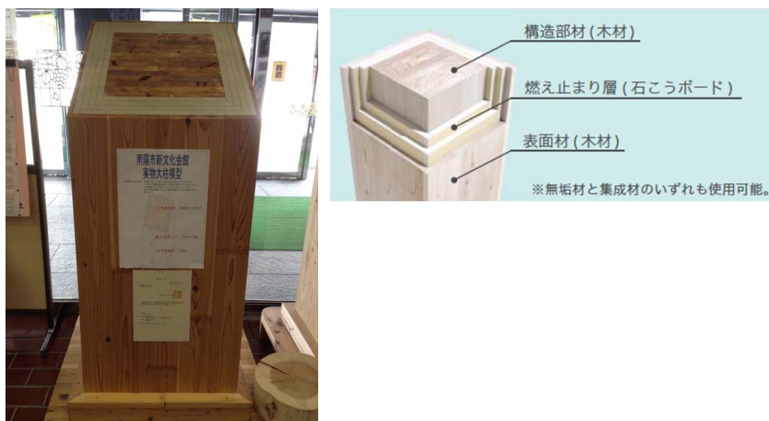
図表 2-15 南陽市新文化会館実物大柱模型／耐火構造部材「COOL WOOD（クールウッド）」
