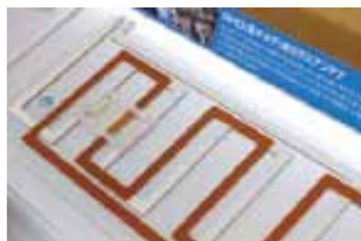
RFID (電子タグ) 用ガラスアンテナ
