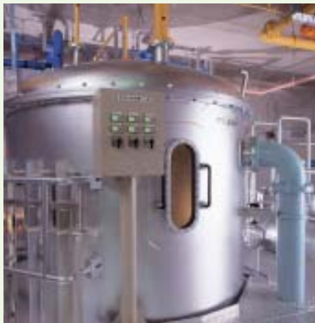
オゾン反応塔 写真提供:水道機工(株)
