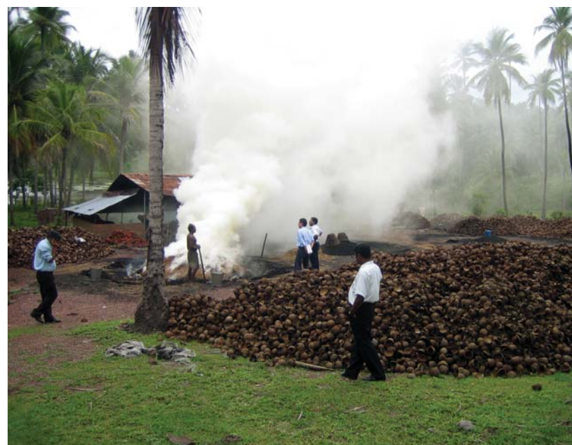
左:リコジェン社の従来のチャコール製造風景(スリランカ)。オーブンピットにシェル(3t/ピット)を敷き詰め、わらで覆い1日かけて蒸し焼き。この集積場には3ピットあり、ローテーションを組みチャコールを製造している。右:原料(コナッツ)および製品(活性炭)、ココナッツシェル(蒸し焼き) チャコール(表面処理) 活性炭の順で製造。
