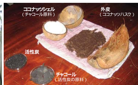
左:リコジェン社の従来のチャコール製造風景(スリランカ)。オーブンピットにシェル(3t/ピット)を敷き詰め、わらで覆い1日かけて蒸し焼き。この集積場には3ピットあり、ローテーションを組みチャコールを製造している。右:原料(コナッツ)および製品(活性炭)、ココナッツシェル(蒸し焼き) チャコール(表面処理) 活性炭の順で製造。
