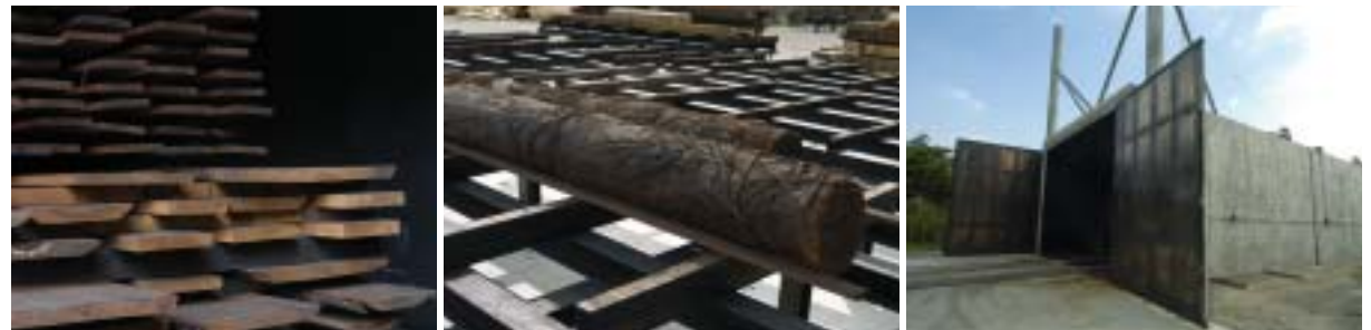
(左)1次処理された原木は製材後、再び4日間かけて燻煙熱処理される。(中)原木の中には、釣り鐘用の撞木(しゆもく)材となる椰子もある。(右)燻煙熱処理炉の原木搬入部分。
