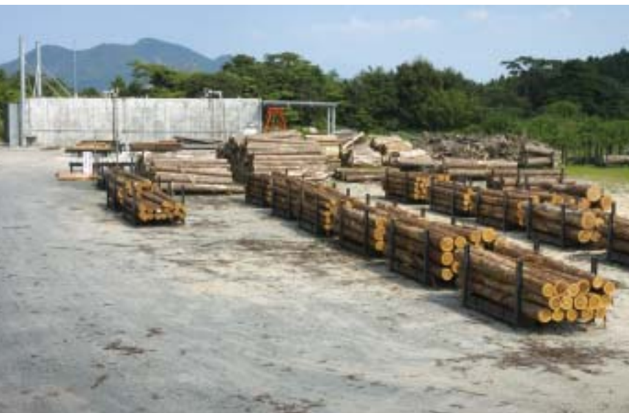
燻煙熱処理2号炉(奥)と処理前の原木。1回当たり、手前に見えるパレット14台分の原木をフォークリフトで炉に入れ、3昼夜かけて熱処理する。
