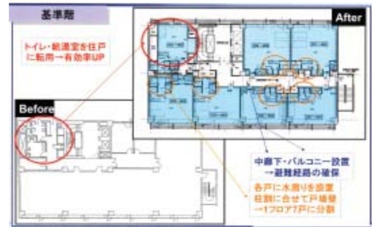
オフィスビルからSOHO住宅にコンバージョンしたラティス青山creator's village「Lattice aoyama」(左)コンバージョン前後の図面(基礎階)(中上)コンバージョン前の外観(右)コンバージョン後の外観(都条例の規定により必要となる避難バルコニーを設置)(中下)コンバージョン前の内装(右)コンバージョン後の内装 日本土地建物(株)資料より作成
