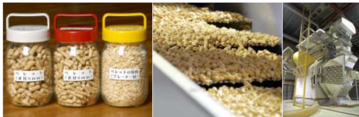
木質ペレットの製品2種と原料のおが屑・かなん屑(写真左)。原料が高圧プレスで圧縮成型されてペレットとなる(写真中)。ペレットの製造設備(写真右)。
