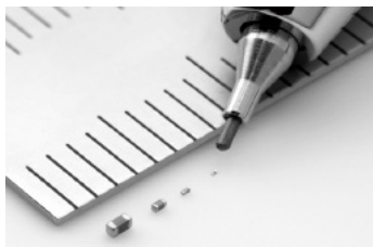
図表3-3 小型化が進む積層セラミックコンデンサ
